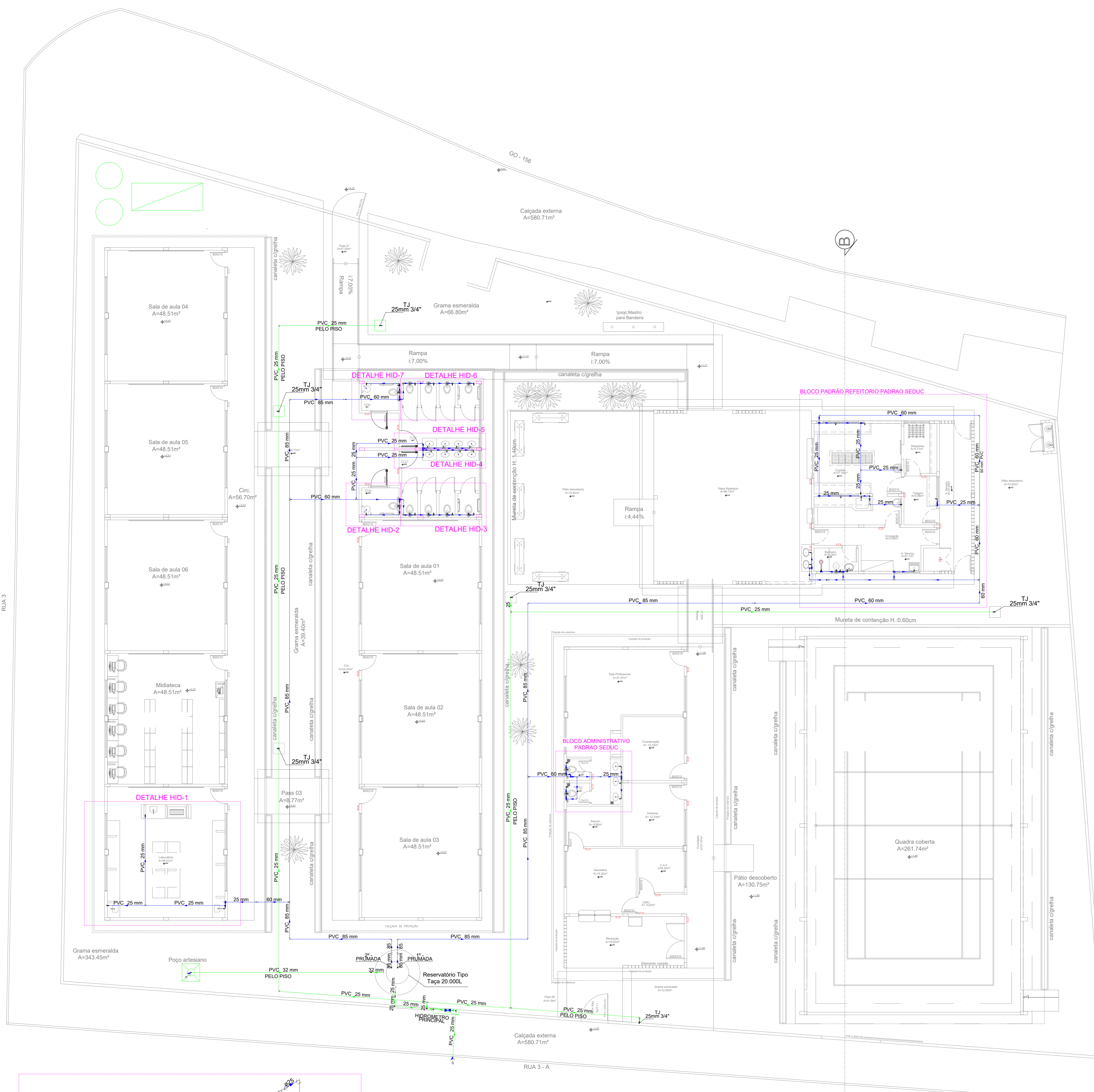
PLANTA BAIXA - PAVIMENTO TERRO - AGUA FRIA ESCALA 1:100
